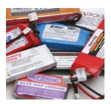
البطارية هي المصدر الأساسي لتغذية النظام بالطائرة الكهربائية.
