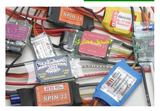
السبيد كنترول هو جهاز بالنظام الكهربائي بالطائرة يتحكم في سرعة دوران المحرك , ودلك بواسطة تلقيه إشارات من الريسيفر .
