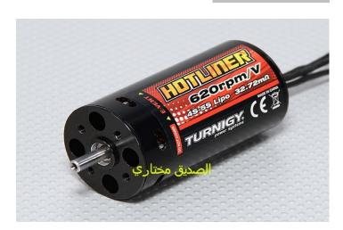
محركات Inrunners لديها قطع المغناطيس مثبث في داخل الهيكل الخارجي للمحرك (جزء ثابت) ويقوم المحور بوسط المحرك الملفوف بالنحاس بالدوران على هدا المحور فمحركات Inrunners لديها دوران جد سريع لكن عزمها يبقى ضعيفا ولكن سرعة الدوران الكبيرة يمكنننا أن نحوولها الى عزم ودلك باستخدام الجير بوكس أو gearbox وهي عبارة عن عجلات مسننة .
